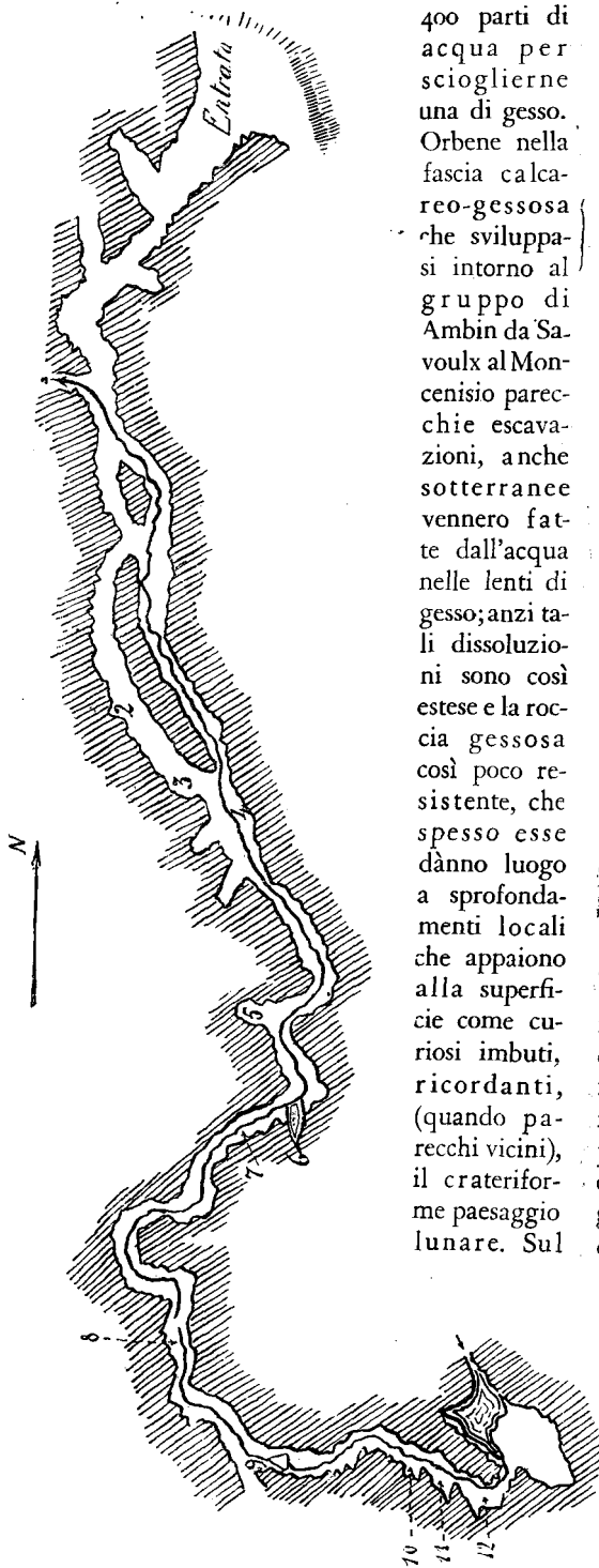
FIG. 5 - PLANIMETRIA DELLA CAVERNA DEL RIO MARTINO IN VAL DI PO, SOPRA CRISSOLO. (Scala di 1 a 1500) (Riliev. C. Maineri).
